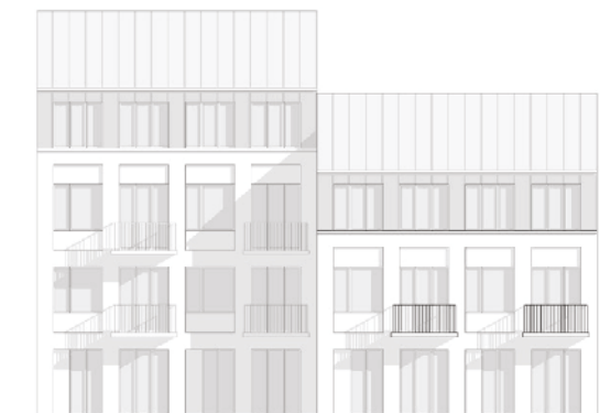
Figur 6.17 Princip for placering af vinduer med skiftevis facadestykke og vindue, placeret symmetrisk over og under hinanden.
